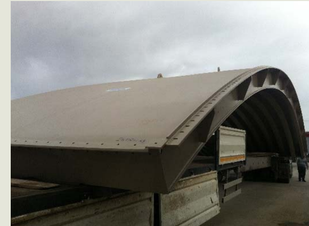
Adana Kavşak Bendi Barajı, Radyal Kapaklar
